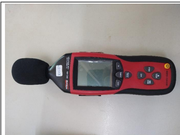
Foto 1 – Decibelímetro utilizado no monitoramento de ruído. (Data:23/09/2020)
