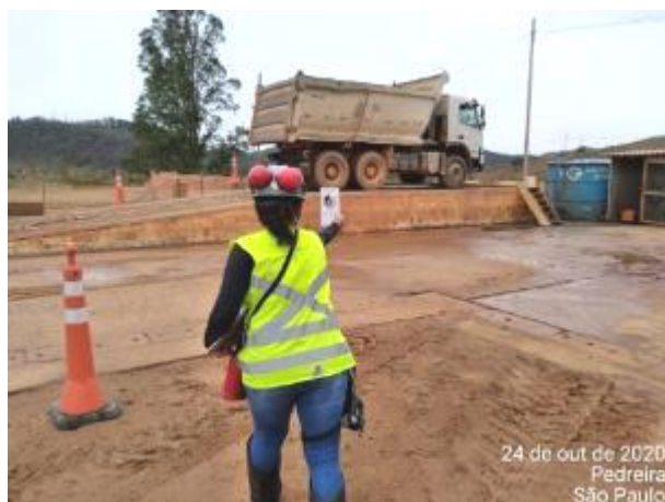
Foto 380 – Monitoramento de fumaça preta em caminhão basculante. (Data:24/10/2020)
