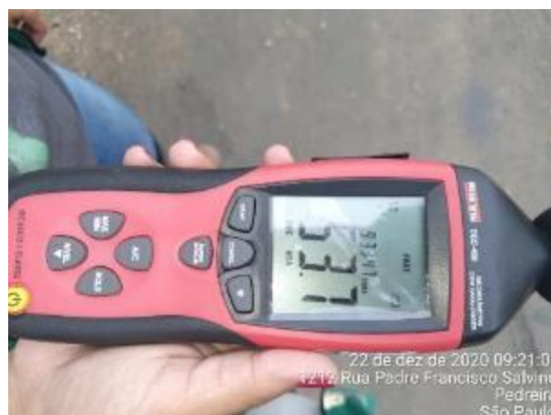
Foto 395 – Equipamento usado para medição de ruído ambiental - decibelímetro. (Data:22/12/2020)
