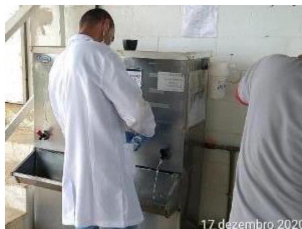
Foto 141 – Coleta de água para análise de potabilidade – bebedouro 02 do canteiro operacional. (Data:17/12/2020)
