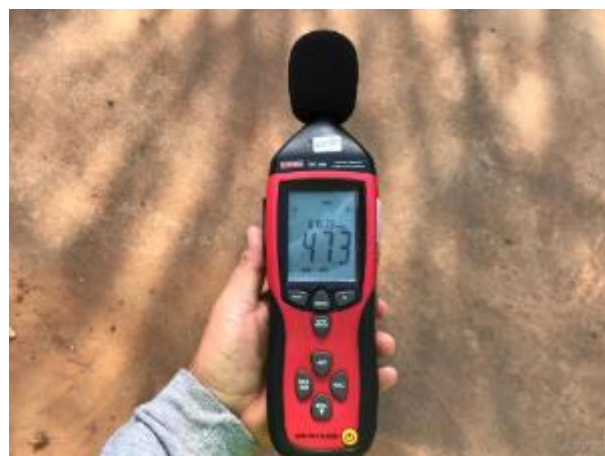
Foto 391 – Equipamento usado para medição de ruído ambiental - decibelímetro. (Data:29/10/2020)
