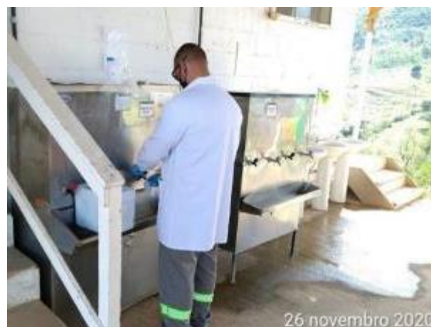
Foto 137 – Coleta de água para análise de potabilidade – bebedouro 02 do canteiro operacional. (Data:26/11/2020)
