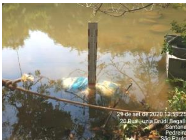
Foto 467 – Instalação da régua de nível para acompanhamento. (Data:29/09/2020)
