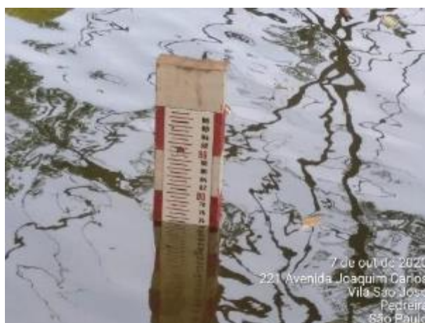
Foto 476 – Régua evidenciando o atendimento de nível da água no local. (Data:07/10/2020)
